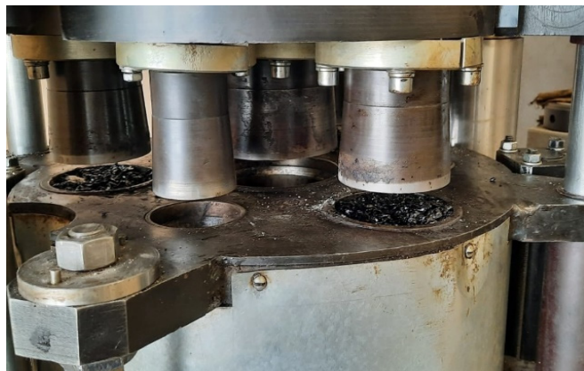
Рисунок 2– Процесс формования образцов на прессе ИП-1000
