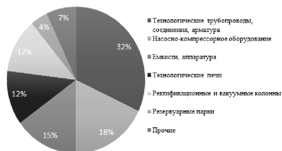
Рис. 1. Распределение аварийных ситуаций по видам технологического оборудования установки
