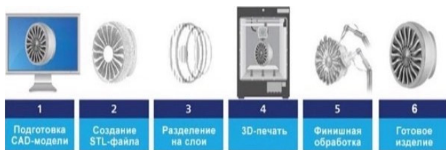
Рис. 2. – Общая схема аддитивного производства
